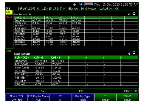
Динамическое распределение спектра (DSS) 5G в канале LTE Вверху: сканирование канала 5G NR с идентификаторами сот Внизу: сканирование канала LTE с идентификаторами сот
